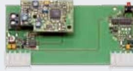
HER 1 vevőegység (1-csatornás) potenciálmentes relékimenettel, külön házban, csatlakoztató vezeték nélkül vagy felpattintható elektronikai panelként a vezérlőszekrényben.
