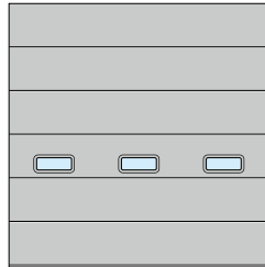
SPU F42, SPU 67 Thermo A-típusú lamellaüvegezés Egyenletes mezőfelosztás
