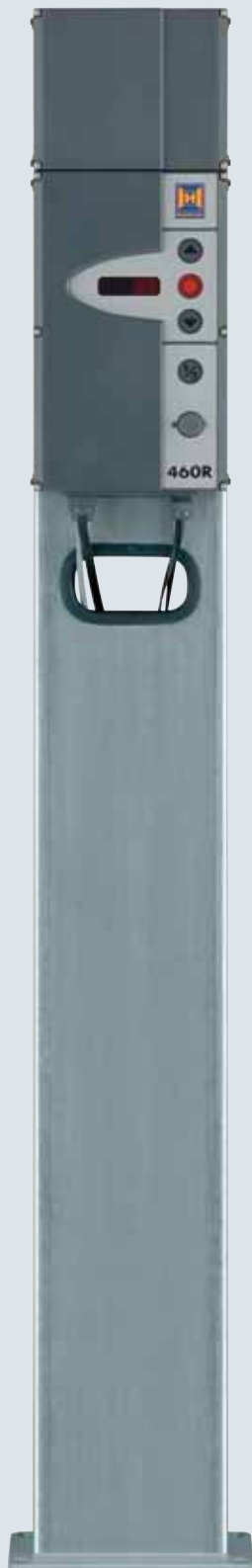
Opcionális STI 1 vezérlő oszlop Max. 2 db bővítőházzal ellátott vezérlés szerelésre Szín: fehéralumínium, RAL 9006 Méretek: 200 x 60 mm, magasság 1660 mm
